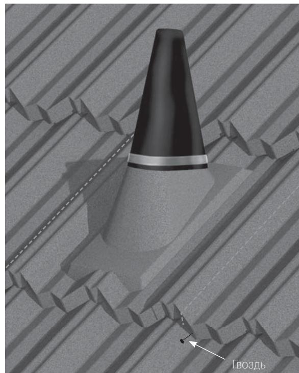
Важно обеспечить гидроизоляцию любых отверстий в подкровельной изоляции вокруг вентиляционных труб. В этом случае используется специальная липкая изоляционная лента.
